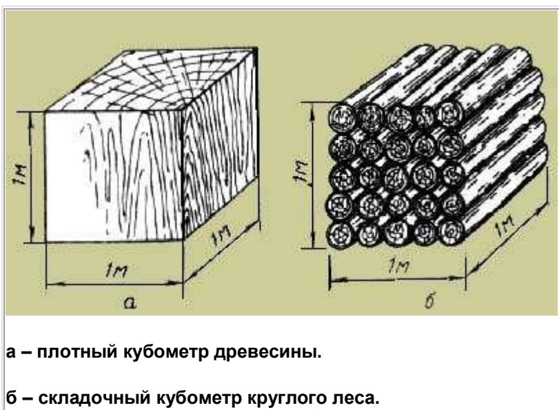
Рис. 2. Определение объема древесины: а – в плотной, б – в складочной мере (по Анучину, 1982)
