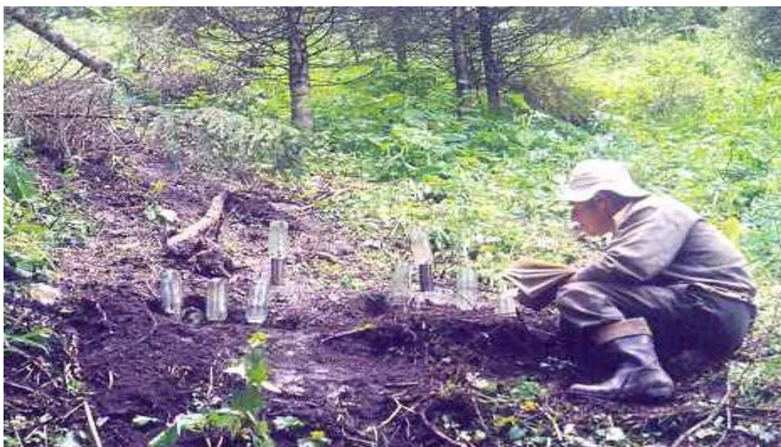
Рис. 2. Определение водопроницаемости методом трубок
