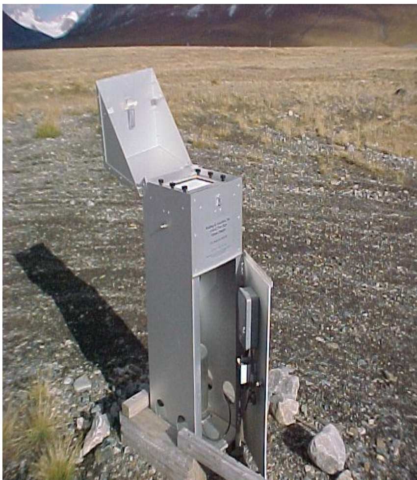
Рис. 2. Отбор проб воздуха аспиратором большого объема, установленном в урочище Барскоон
